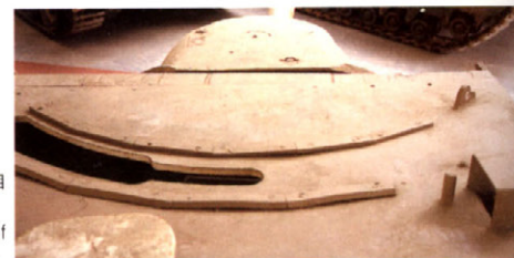
▶最後期型照準器カバーのレール（カバー自 体は失われている）。 Sight opening armoured traverse cover of final production type (cover is missing).
