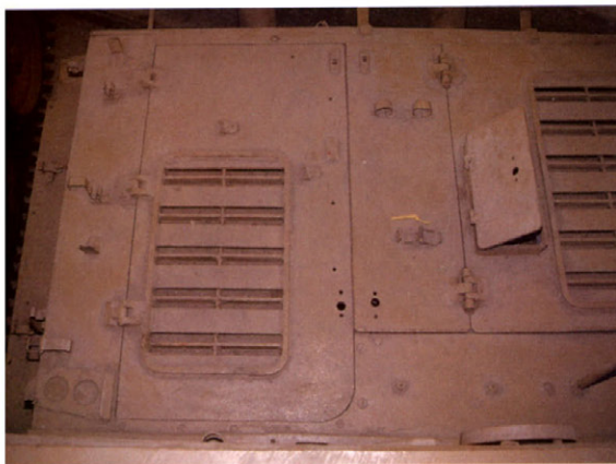
機関室上部、開きかけている小さなハッチは冷却水注入孔。 Deck (top) half opened small hatch is for water filler. 54
