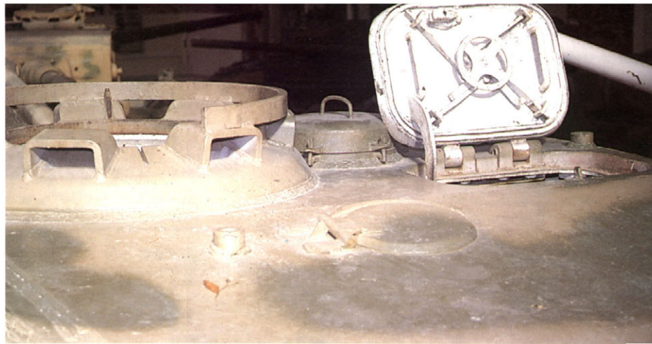
後方から見た車長用キューボラと装填手用ハッチ、手前は信号弾発射用の小ハッチ。 Commander's cupola and loader's hatch (inside), small hatch for signal pistol.
