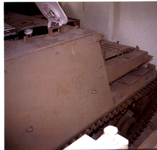
冷却空気は機関室天井に設置された2基の大型ファンにより車体右側面の開口部から吸入され、車体左側面の開口部から排出された。 Air was drawn into the engine compartment through a opening in the right-hand side of the hull and expelled through a opening on the left.
