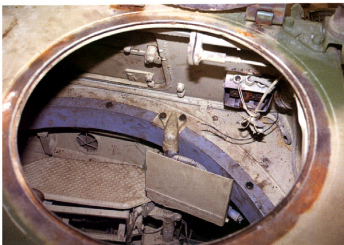
◀車長ハッチから見た車内、砲塔後部ハッチのロックと蓋のとれた砲塔の配電盤がみえる。 Interior view from commanders's hatch shows, the lock for turret's rear hatch and the turret's fuse box.
