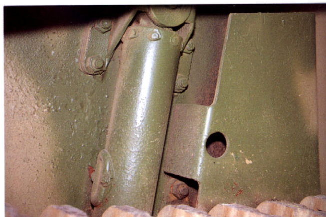
車体側面下部の転輪用のダンパー（緩衝器）。 Damper(for road wheel)of lower hull side.
