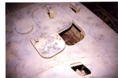
IV号駆逐戦車L48の車長用ハッチ、手前の前期型照準器カバーに注意。
