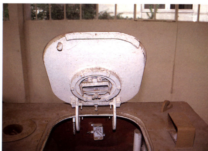
▶ 車長用ハッチの内側、ペリスコープ自体は失われている。 Inside of commander's hatch, the periscope is missing.
