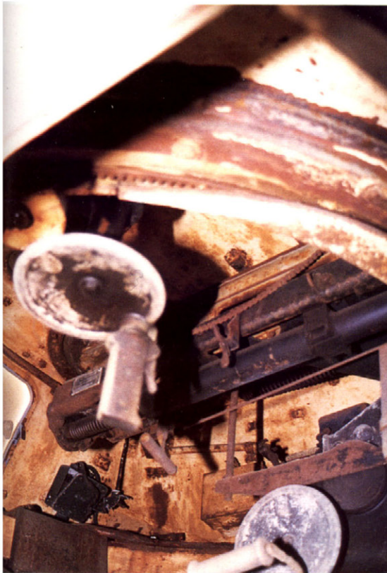
射手側に床から見上げた砲塔内部、上は砲塔旋回ハンドル、下は砲 の俯仰ハンドル。 Interior view from gunner's side floor, shows the turret tra- verse handwheel (above) and elevation handwheel for gun (below)
