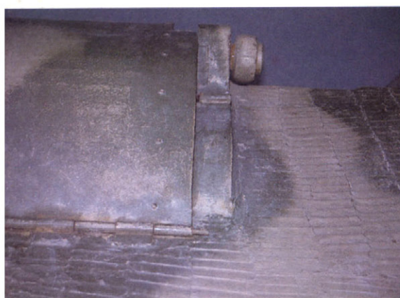
上から見た前部フェンダーと牽引フック。 Frontal dust shield and towing hold with hook (top).
