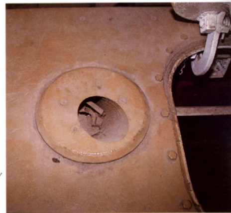
▶Sマイン発射器（ナーフェルタイドウング ス・ヴァッフエ；近接防衛兵器） S-mine thrower (Nahverteidigungs waffe; Close-in defence weapon).
