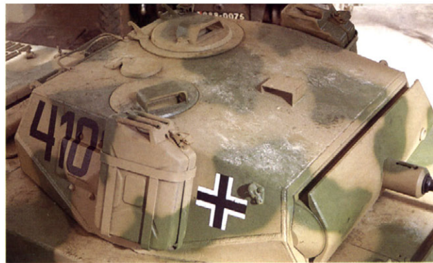
上から見た砲塔、手前から、砲手用回転式ペリスコープ、信号弾用小ハッチ、回転式ペリスコープつき車長ハッチ。 Top view of turret, from this side, rotating periscope for gunner, signal hatch and commander's hatch with rotating periscope.
