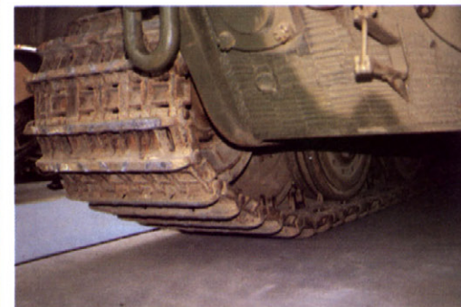
左から、キャタピラ、キャタピラ緊張装置蓋、ジャッキ留め金具 From left, track, track tension unit cover and jack brackets
