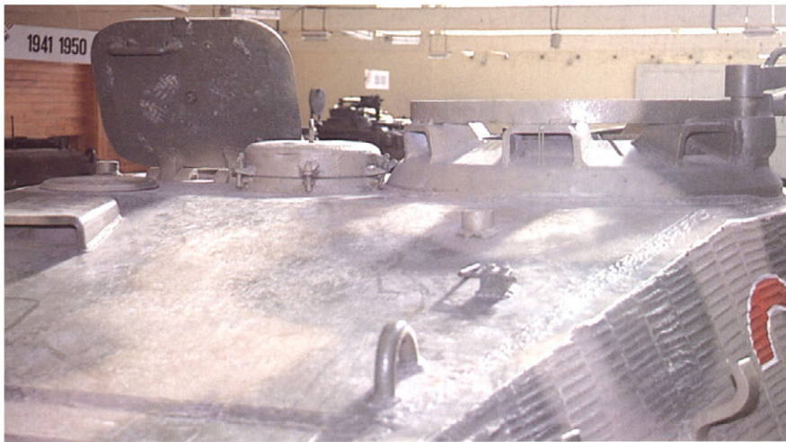
砲塔上部、左から、装填手用ペリスコープ(潜望鏡)、装填手用ハッチ、防水カバーを装着したベンチレーター(換気扇)、車長用キューボラ。 From left to right, periscope for loader's hatch, ventilating fan with water proof cover, and commander's cupola.
