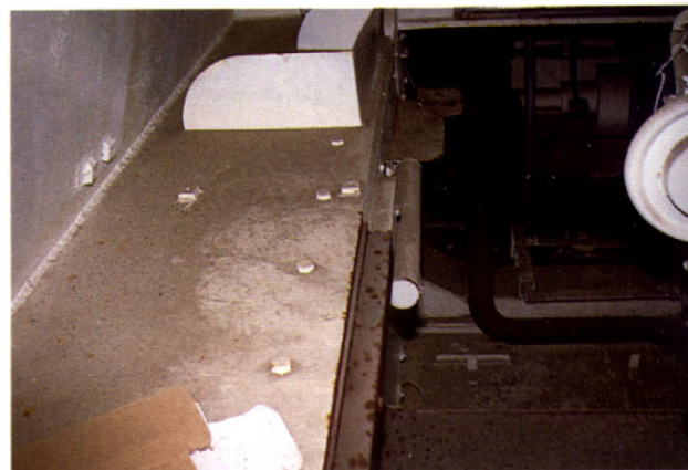
向かって右側のキャタピラの上に張りだした車体側面部内側、上にみえるのは操 縦手用の物入れ。 Driver's kit bin on left sponson.
