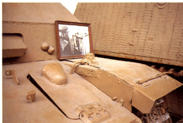
冷却空気吸入用のふくらみのついたブレーキ点検ハッチ。 Air intake and access hatch for steering brakes.
