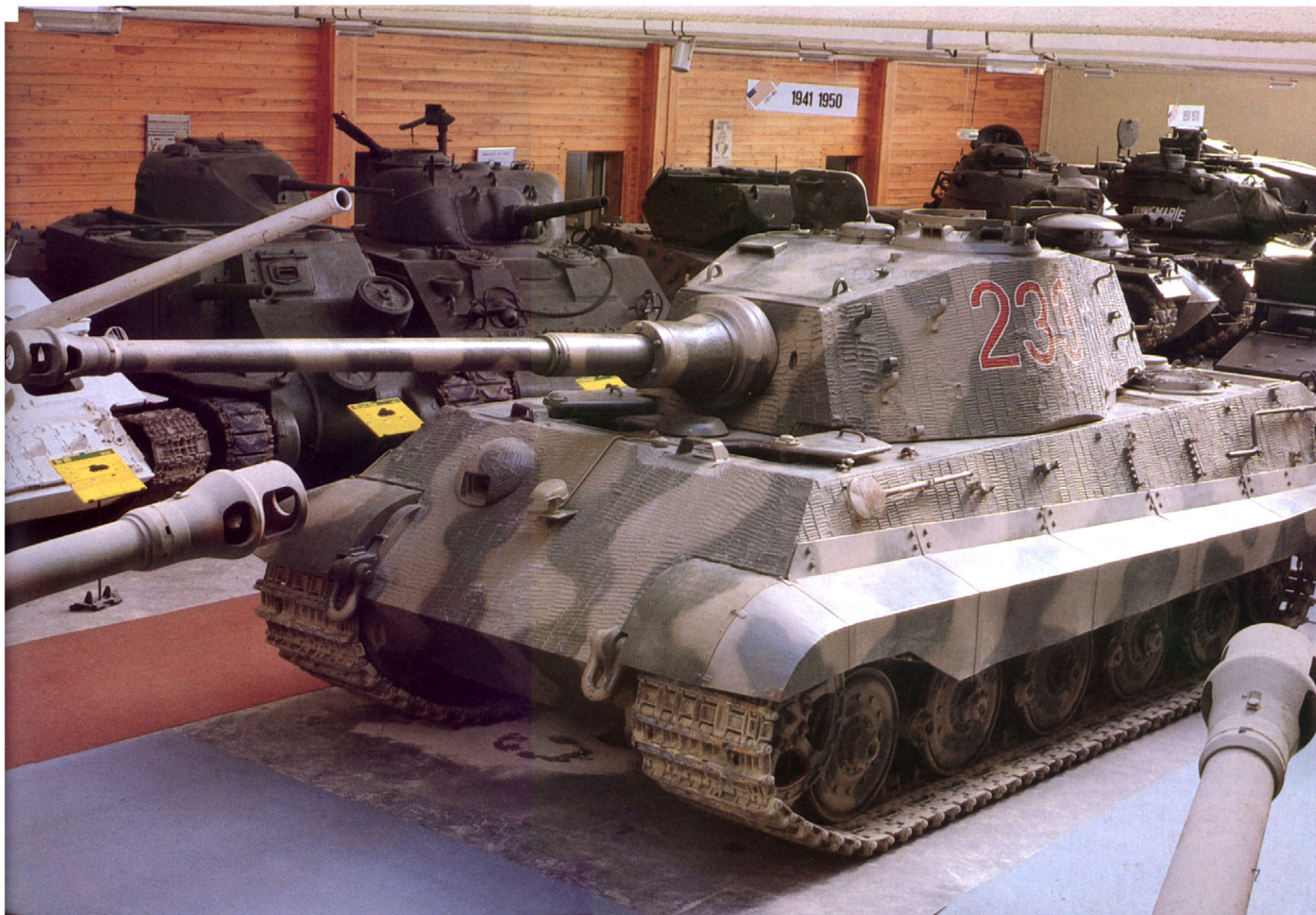
リングつきのザウコップ(豚の頭; 鑄造防盾)。 'Saukopf' (Boar's head; cast gun mantlet) with ring type.
