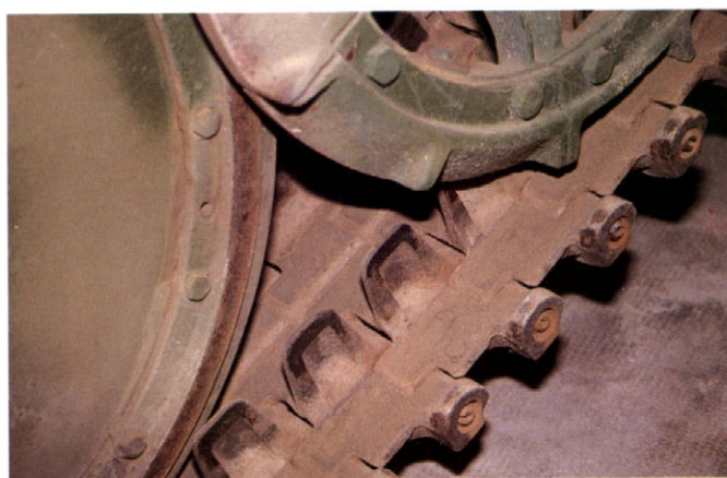
キャタピラと誘導輪、キャタピラの脱落防止ガイドに注意。 Track and idler wheel;note the horns of the track links.
