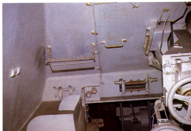
操縦手席、IV号戦車と同形の操縦手用、軸回転式バイザーのハンドルがみえる。 防弾ガラスはなくなっている。 Interior view of driver's position shows the handles of the pivoting armour cover for the driver's visor (standard type for Pzkw IV). Its bullet proof glass is missing.
