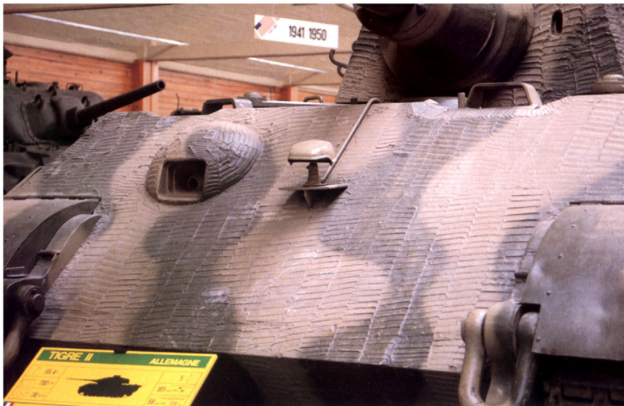
車体前面装甲板は傾斜角50度、150ミリの厚さがある。 The frontal armour of the hull is sloped 50° and its thickness is 150mm.
