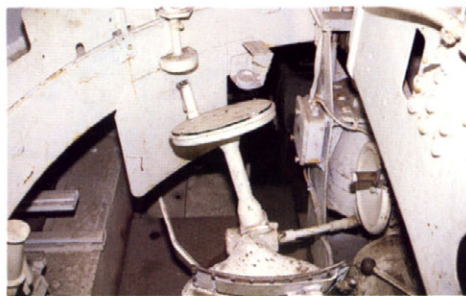
手で砲塔を一回転させるには、このハンドルを700回まわさなければならない。右に見えるのは砲の俯仰ハンドル。 It required 700 turns of the gunner's traverse handwheel to complete one revolution of the turret. The other handwheel (right) is to elevate the gun.
