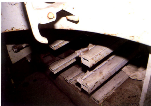
戦闘室中央（砲手側）の弾庫、ここには7発の砲弾が収納される。 Center of fighting compartment (beside gunner), it stowed 7 rounds.
