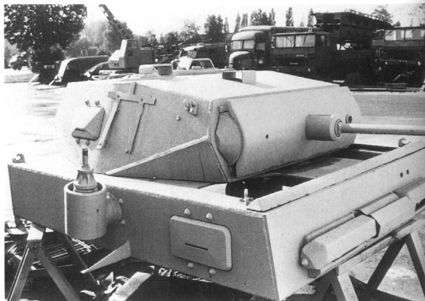
復元前の砲塔と上部機関室、操縦手と無線手用のハッチはとれているのではなく、内側に開いている。 Unrestored turret and superstructure, the driver's and radio operator's hatches opened, and those hatch covers are inside.
