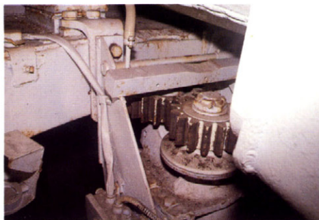
主砲の真下に位置する砲塔旋回ギア。最高速で動力旋回させると砲塔は19秒で一回転する。 Turret traverse gear under gun. A complete 360° traverse in the highest ratio with power traverse system takes 19 seconds.
