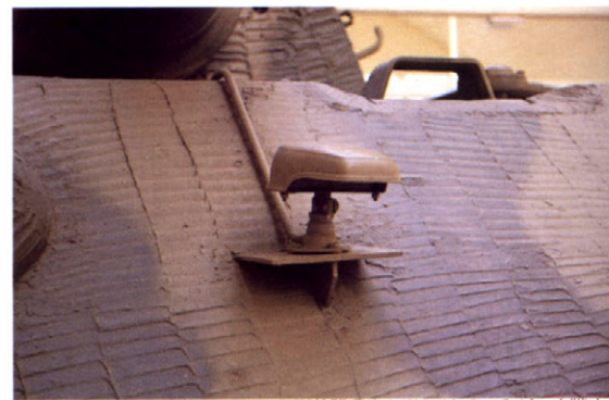
ソミュール製のこの車輻はノテック型前照灯をとりつけているが、大戦中のティーガーII型はボッシュ型前照灯をとりつけていた。台座も復元時にやった物のようだ。 The Saumur's Tiger II is equipped with the Notek type head light but most of Tiger IIs were equipped with a Bosh type light in WWII
