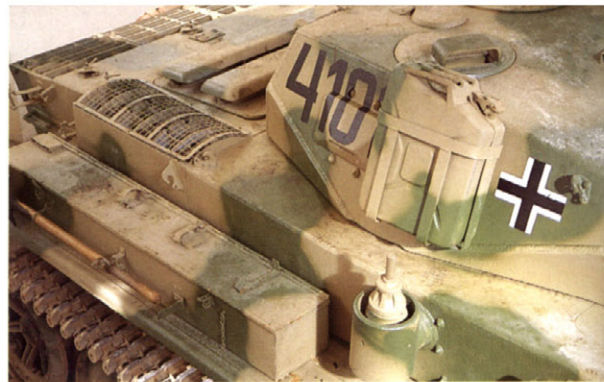
フェンダー上の細長い箱は2センチ戦車砲の予備砲身やそのクリーニング・ロッドなどを収めるための物と思われる。 The long and narrow box on a fender seems to be for storage of the spare barrel of 2cm tank gun and its cleaning rods.
