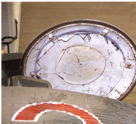
▶車長ハッチの裏側、実際にはここにあるはずの、頭部保護用のパッドはとれてしまっている。 Inside of commander's hatch, the head pad is missing.
