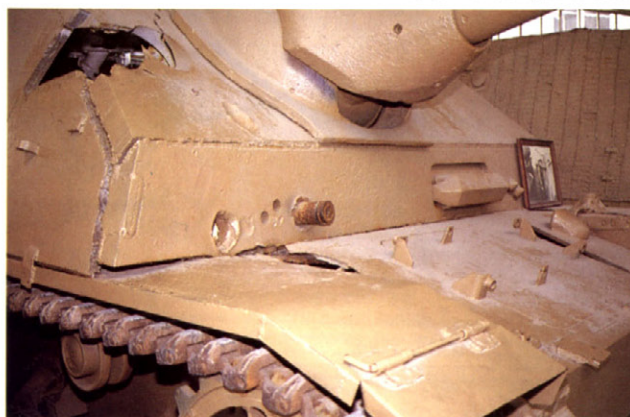
80ミリの前面装甲板に食い込んだシャーマンの75ミリ砲弾に注意。 Note the Sherman's 75mm projectile sticking in the 80mm thick frontal armour.
