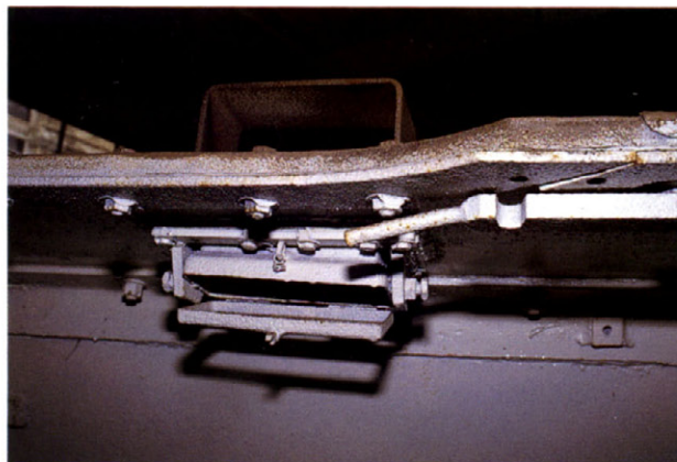
ハッチ横の車長用ペリスコープマウントとハッチのロックレバー。 Commander's periscope mount (beside the hatch) and lock lever for commander's hatch.
