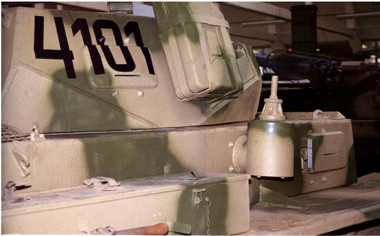
III号戦車のG～J型初期にとりつけられた物と同形の砲手用ビジョンポート、内部のレバーで開閉することができる。 Gunner's vision port it is the same armoured cover as PzKpfw III Ausf G～J early production type's.
