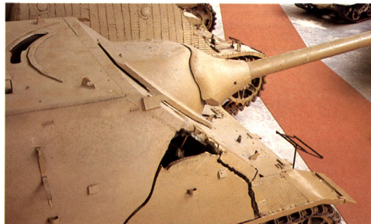
被弾で亀裂の入った装甲板、高初速弾命中の強い衝撃を受けると装甲板はしばしば割れる、溶接箇所でも割れる場合が多い。(装甲板は曲がらない) The high-velocity projectile hits cracked and buckle the armour plate (armour plate does not bent), and occasionally pop open welded seams.
