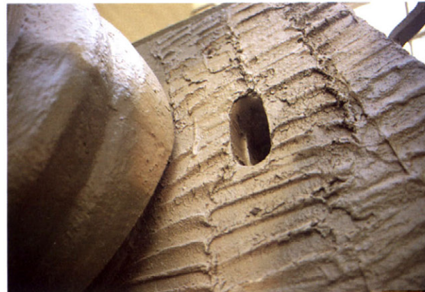
砲塔正面、TZF9b/単眼式照準器の照準口。 Port for TZF9b/1 monocular sighting telescope.
