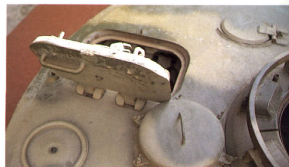
上から見た装填手用ハッチ、左下にSマイン発射器(近接防御兵器)をとりはずした跡の穴を塞いだ変な円盤が見える。 Loader's hatch (top), S-mine thrower (Nahverteidigungswaffe; Close in defence weapon) is missing. Note the hole is covered with circular plate.
