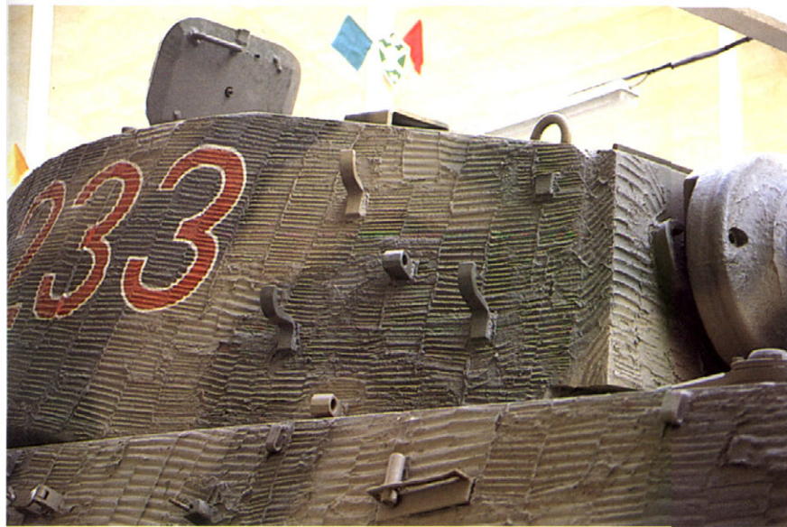
左前方から見た砲塔、増加装甲を兼ねる予備キャタピラ用のフックが見える。 Left hand side-front, the hooks are for the spare track links.
