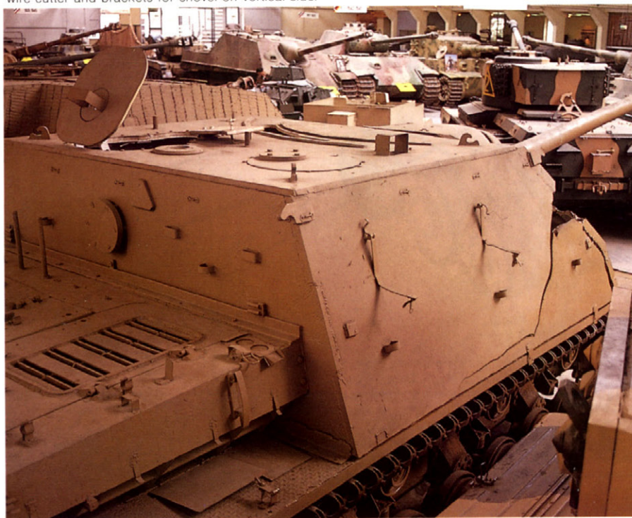
機関室上部の金具類、手前から斧、かなてこ、ワイヤーカッター、手前側面にはスコップとリッパ金具がみえる。 Brackets on top of engine deck, from this side axe, long crowbar, wire cutter and brackets for shovel on vertical side.
