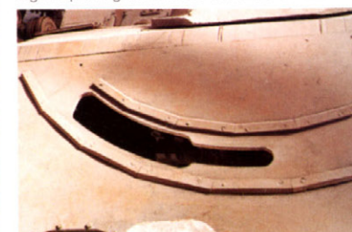
IV号駆逐戦車L70(A)の最後期型照準器カバーのレール(カバー自体は失われている)。
