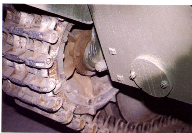
アイドラーホイール内側とキャタピラの緊張を調整するボルト。 Inside of idler wheel and track tensioner bolt head.
