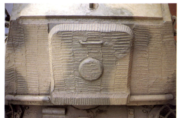
砲塔後部の脱出ハッチ、真ん中にピストルポート(拳銃発射孔)装甲栓がある。 Rear escape hatch of turret, it has the armoured plug for the pistol port.
