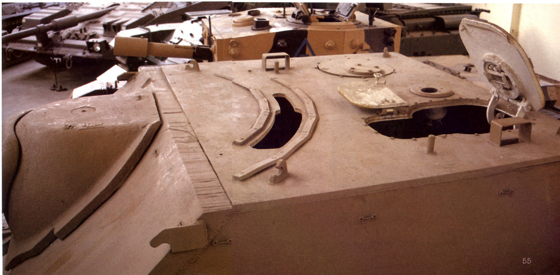
開状態の砲隊鏡用小ハッチ (ネジ式のロックに注意) と、車長用 360 度回転式ペリスコープつきハッチ (回転式ペリスコープの基部がみえる)。 Binocular telescope observation small hatch (Note its lock) and commander's 360° rotating periscope fitted in hatch (The inside view shows the mount of its periscope).
