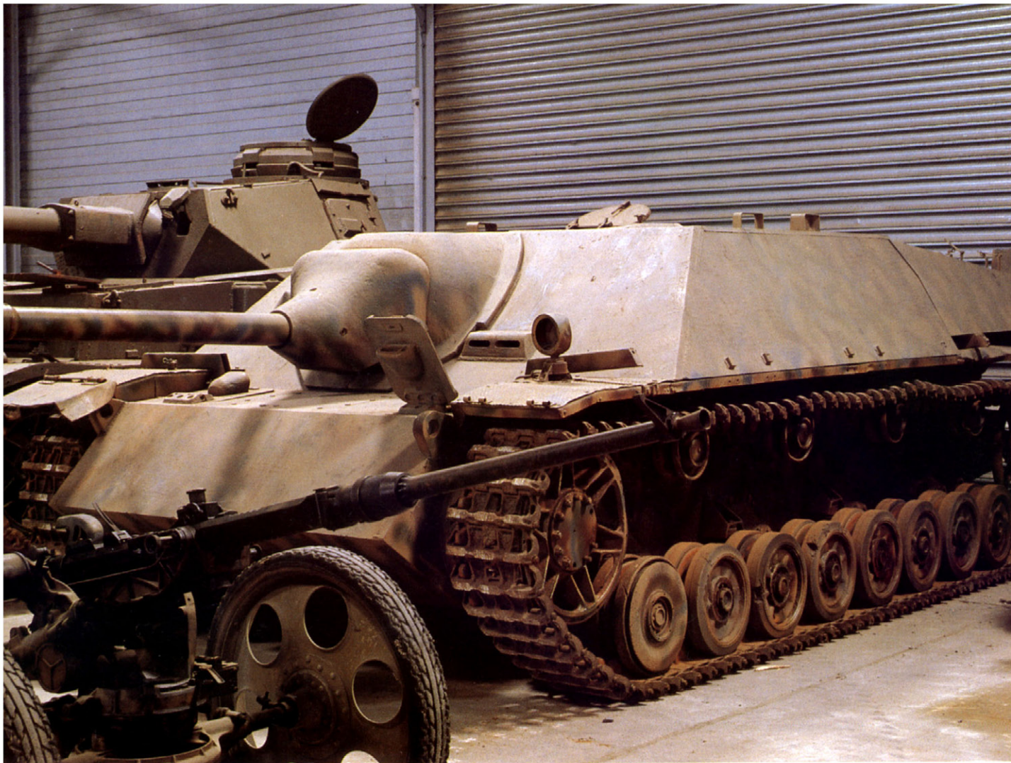
一番前の全鋼製転輪を含めて、前部の転輪のハブがとれてしまっているのに注意。 Note the all armoured hub-caps of road wheels are missing.
