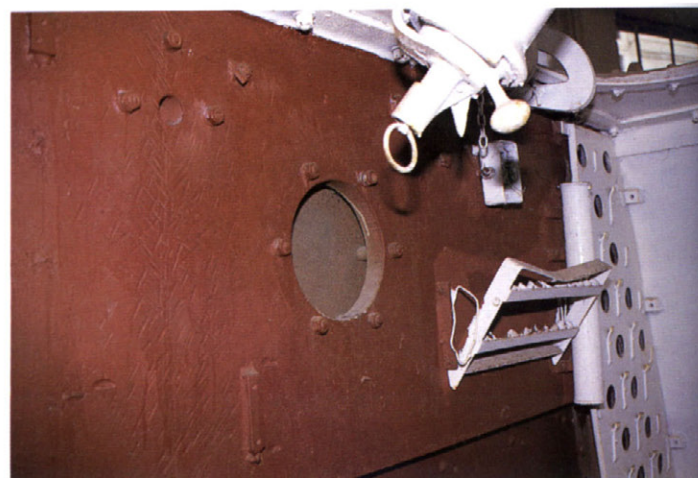
赤く塗られた戦闘室後部装甲板と機関室隔壁、丸い穴はベンチレーターファンがついていた跡、その横には車長用シートのフレームがみえる。
