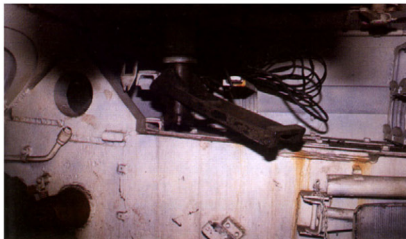
無線手席、真ん中に見えるのは軸回転式ハッチの開閉ハンドル。 Radio operator's position, note the opening and closing handle of the pivoting hatch.
