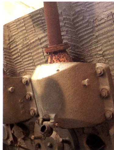
右排気管の装甲プロテクター、エンジン始動時には、下にぶらさがっている輪に始動用クランクを通して保持する。9ページのイラスト参照。 Right hand armoured protector of exhaust pipe, the starter crank handle was supported by the hanging ring under it when the engine started (See page 9).
