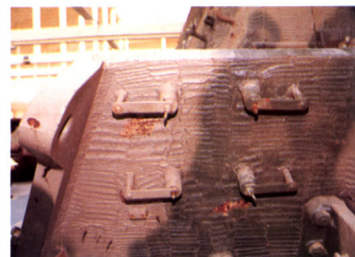
牽引用シャックルの留め金具、上下に一個ずつとりつけられる。 Brackets for a couple of towing clevises.
